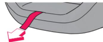
Bei Fahrzeugen mit Serienkopfstütze kann durch Verstellen bzw. Demontage dieser Kopfstütze ein besserer Einbau des Sitzes erzielt werden. Beachten Sie, dass die Fahrzeugkopfstütze wieder in der korrekten Position eingebaut werden muss, wenn ein Erwachsener mitreist.
