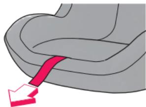
Ziehen Sie den Zentralgurt TWINFIX (08) nach vorn, bis die TWINFIX-Adapter (10) vollständig eingefahren sind!
