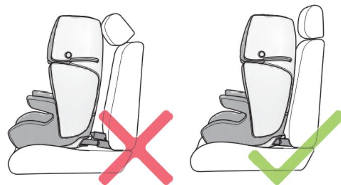
Ziehen Sie den Zentralgurt TWINFIX (08) nach vorn und führen Sie den CONCORD TRANSFORMER nach hinten, bis er möglichst dicht/bündig an der Rücklehne des Autositzes anliegt.
