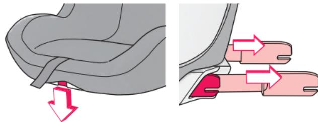
Stellen Sie den CONCORD TRANSFORMER in Fahrtrichtung auf den mit ISOFIX-Aufnahmen ausgestatteten Fahrzeugsitz bzw. Sitzbank.
