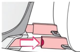
Zum Demontieren des CONCORD TRANSFORMER, drücken sie den Bedienknopf TWINFIX (09) nach unten und bewegen Sie den Sitz ganz nach vorn. Drücken Sie nun die Sicherungsknöpfe an den Außenseiten der TWINFIX-Adapter (10), bis sich die Sicherheitshaken öffnen und die Adapter herauspringen.
