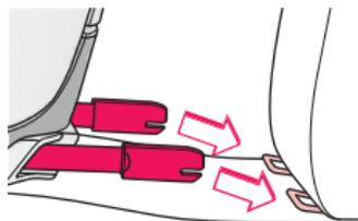
Schieben Sie beide TWINFIX-Adapter (10) auf die ISOFIX-Aufnahmen im Fahrzeug, bis die Verschlussmechanismen hörbar eingerastet sind.
