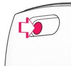
Zum Anpassen des CONCORD TRANSFORMER an die Größe des Kindes, drücken Sie das Kopfteil (01) leicht nach unten. Drücken Sie nun den Bedienknopf Größenanpassung (04) auf der Rückseite der
