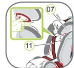
Правильно отрегулированный подголовник 07 обеспечивает оптимальное положение диагонального ремня безопасности 11, предоставляя оптимальную защиту для ребенка. Подголовник 07 должен быть отрегулирован таким образом, чтобы между подголовником 07 и плечами ребенка сохранялось расстояние в два пальца.
